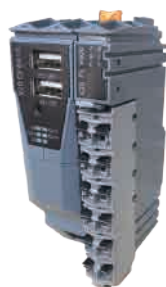
A9-166 处理器, 128 MB DDR3 SDRAM, 8 kB FRAM, 256 MB 闪存驱动器ARM Cortex , 2个USB接口, 1个Ethernet接口, 一个X2X Link, 1个RS232接口, 1个CAN接口
