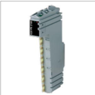
24 VDC 电源模块用于内部 I/O 供电
